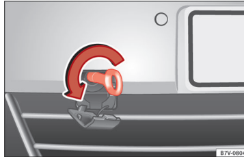
104. ábra A lökhárító jobb első részében: vonószem becsavarása.
