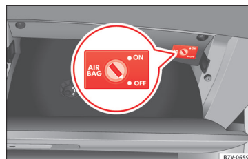
93. ábra A kesztyűtartóban, utasoldalon elől: Kulcsos kapcsoló az utasoldali első légzsák kikapcsolásához.
