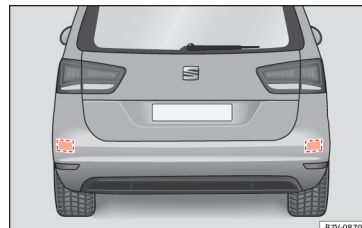
222. ábra A jármű hátsó nézete: a radar-érzékelők tartományai.
