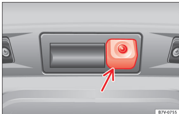
215. ábra A csomagterajtóban: tolatási asszisztens kamerájának beépítési helye.
