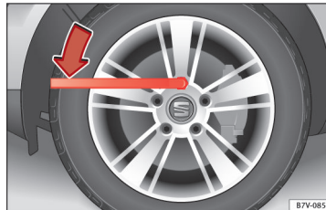
68. ábra Kerékcsovere: kerékcsovarok meglazítása.
