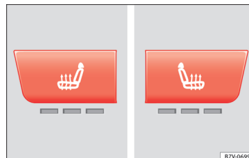
156. ábra A középkonzol részlete: az első ülés fűtésének szabályzója Climatronic-kal szerelt járműveknél.
