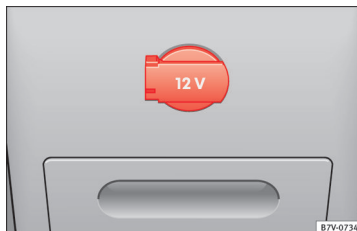
194. ábra A középkonzol hátsó része: 12 voltos csatlakozóaljzat.
