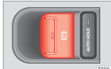
202. ábra A középsofőr konzol részlete: elektronikus parkolófék kapcsolója.
