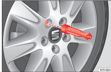
72. ábra Kerékcseré: a kerécsavarokat a csavarhúzó markolatával csavarja le.
