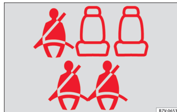
84. ábra Példa a hátsó ülések (ebben az esetben 7 ülés) övállapotának kijelzésére a műszerfalban: felül a második üléssor, alul a harmadik üléssor.
