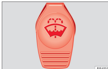
248. ábra A motortérben: az ablakmosó folyadék tartályának fedele.
