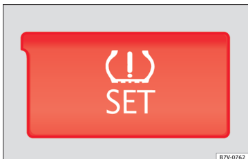
229. ábra A középkonzol részlete: gomb a gumiabroncsnyomás-ellenőrzés kijelzőjéhez
