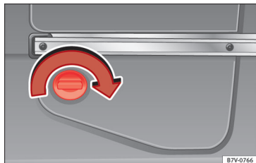
237. ábra A csomagtérben bal oldalon hátul: AdBlue-tartály, egy burkolat mögött.
