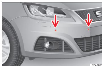
210. ábra A parkolási távolság figyelés érzékelői az első lökhárítóban.
