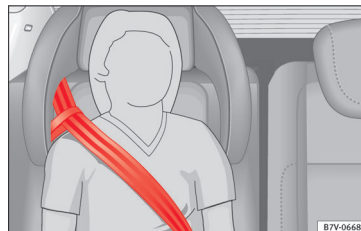
97. ábra Integrált gyermekülés: övpánt helyzete az övvezetővel.
