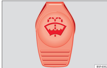
59. ábra A motortérben: az ablakmosó folyadék tartályának fedele.
