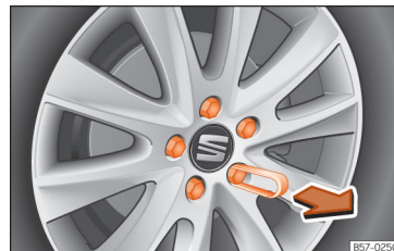
73. ábra Kerék: kerékcőcsavarok védőkupakokkal.
