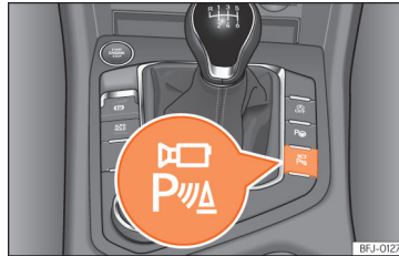
292. ábra Középkonzol: Gombok a környezetfigyelés manuális be-/kikapcsolásához a parkolásegítő rendszerrel ([A]) vagy a hátsó Park Pilot-tal ([B]) összekötve.
