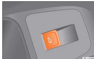
126. ábra A vezető ajtajában: gomb a csomagtérajtó nyitásához és zárásához.
