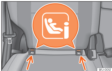
37. ábra Második ülésor szélső ülései: ISO-FIX/i-Size rögzítőszemek.
