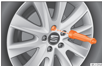
78. ábra Kerék: a kerécsavarokat a csavarhúzó markolatával csavarja le.
