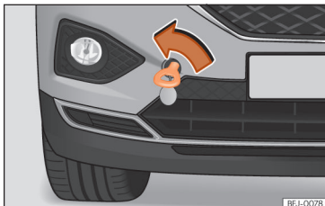
99. ábra Az első lökhárító jobb oldalán: becsavarja a vonószemet.
