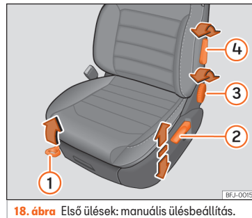
18. ábra Első ülések: manuális ülésbeállítás.
