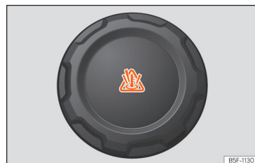
62. ábra Motortér: motor hűtőfolyadék kiegyenlítő tartályának fedele
