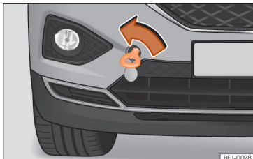
79. ábra Az első lökhárító jobb oldali részlete: becsavart vonószem
