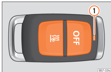
190. ábra Állóhelyzeti fűtés: rádiós távirányítóval
