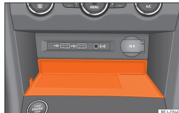
242. ábra A középkonzolban: Tartó a mobiltelefon párosításához.
