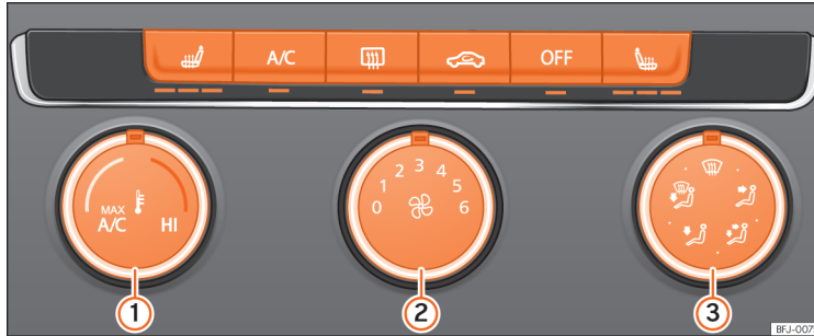
58. ábra A középkonzolban: manuális klímaberendezés kezelőelemei.
