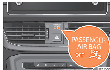
29. ábra Műszerfal: utasoldali első légszák kikapcsolt állapotát jelző ellenőrző lámpa.
