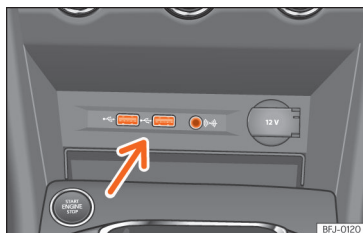
239. ábra Középkonzol: USB/AUX-IN-bemenet
