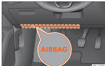
30. ábra A vezető oldalán: a térdlégszák beépítési helye.
