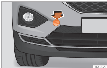
98. ábra Az első lökhárító jobb oldalán: távolítsa el a védőburkolatot
