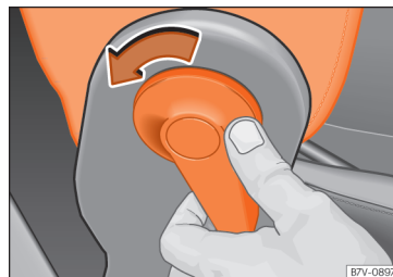
149. ábra Utasoldali első ülés dönthető háttámláját reteszelve ki.
