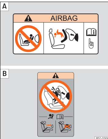
35. ábra légzsák (Airbag) matrica: a jobb oldali napellenzőn A és a jobb oldali első ajtókeret hátsó részén B .
