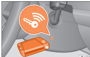
244. ábra A kormányoszlop jobb oldalán: szükséghelyzeti indítás.
