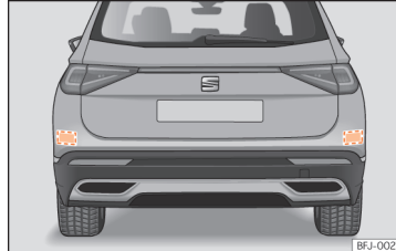
274. ábra A jármű hátsó nézete: a radarérzékelők tartományai.
