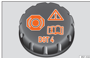
63. ábra Motortér: fékfolyadék tartályának fedele
