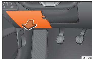
55. ábra A vezető oldalán a műszerfalban: biztosítékház fedele.
