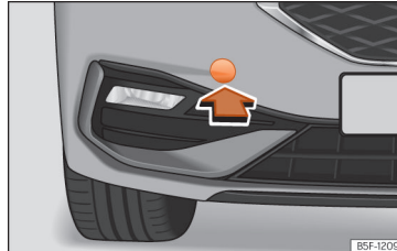
51. ábra Az első lökhárító jobb oldalán: távolítsa el a takaróelemet.
