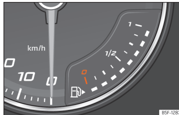
67. ábra Analóg műszerfalbetét: Üzemanyag-tartalék kijelzése
