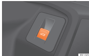
94. ábra A vezető ajtaján: gomb a csomagtérajtó nyitáshoz és zárásához.
