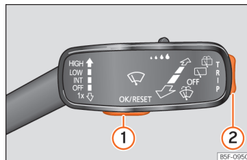
71. ábra Ablaktörlő kapcsolókar: vezérlőgombok.
