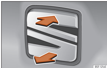
92. ábra Csomagtérajtó: nyitás kívülről.
