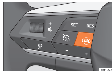
73. ábra A multifunkciós kormánykerék bal oldali részlete: kapcsológomb a vezetéssegítő rendszerek kezeléséhez (modellfüggő).
