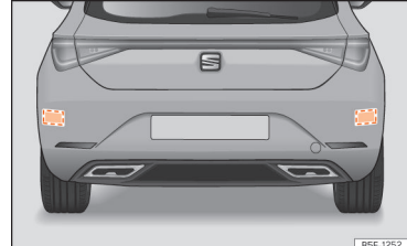
170. ábra Jármű hátsó nézete: a radarérzékelők tartományai.
