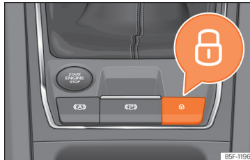
86. ábra A középkonzolban: központi zár kapcsoló
