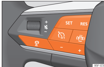
179. ábra A multifunkciós kormánykeréken: kapcsolók az ACC kezeléséhez
