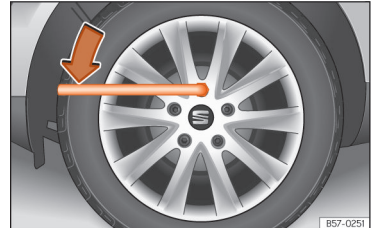
43. ábra Kerécsere: kerécsavarok meglazítása.
