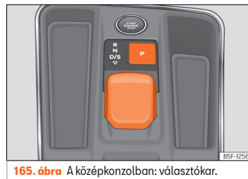
165. ábra A középkonzolon: választókar.
