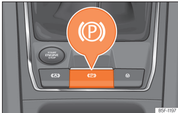
195. ábra A középkonzol alsó tartományában: elektronikus parkolófék kapcsolója.
