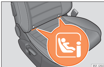
33. ábra Utasoldali első ülés: ISOFIX/i-Size rögzítőszemek.
