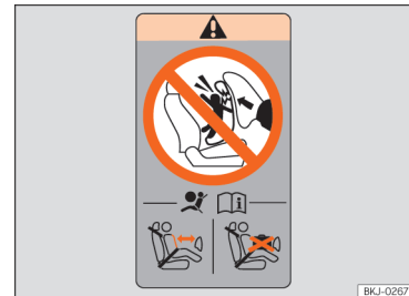
31. ábra Légzsák matrica: jobb oldali első ajtókeret hátsó élén
