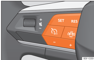
174. ábra A multifunkciós kormánykeréken: gombok a sebességhatároló kezeléséhez
