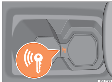
162. ábra A középkonzolban: szükséghelyzeti indítás.
