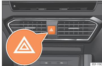
103. ábra Műszerfal: vészvillogó kapcsolója.
