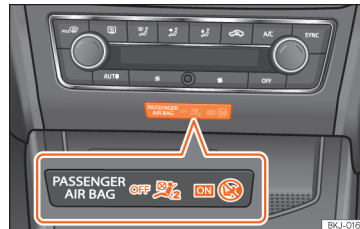
95. ábra Műszerfal középső része: ellenőrző lámpa a kikapcsolt utasoldali első légzsákhoz.
