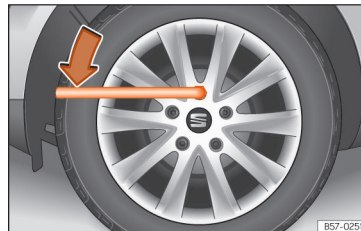
72. ábra Keréksere: Keréksavarak meglazítása
