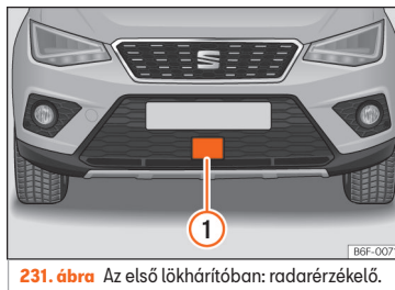
231. ábra Az első lökhárítóban: radarérzékelő.
