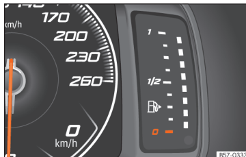
122. ábra Szabadon konfigurálható műszerfalbetét: Üzemanyag-mennyiség kijelzése.
