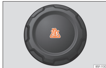
60. ábra Motortér: motor hűtőfolyadék kiegészítő tartályának fedele
