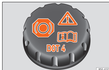
61. ábra Motortér: fékfolyadék tartályának fedele
