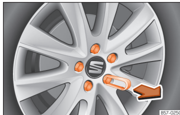
71. ábra Kerék: keréksavarak védőkupakokkal.
