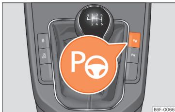
248. ábra A középkonzolban: kapcsológomb a parkolási kormányzási asszisztens bekapcsolásához.
