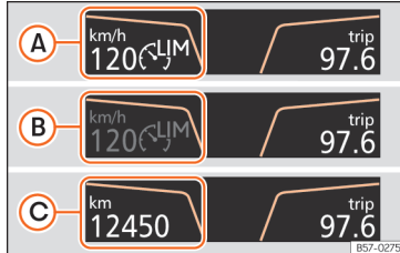
227. ábra A műszerfalbetét képernyőjén: sebességhatároló állapotának kijelzése.
