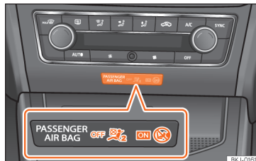
25. ábra Műszerfal középső része: ellenőrző lámpa a kikapcsolt utasoldali első légszákhoz.
