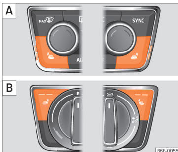
150. ábra A középkonzolban: az első ülések ülésfűtésének szabályozója. A: Climatronic-kal felszerelt kivitel. B: manuális klímaberendezéssel felszerelt kivitel.
