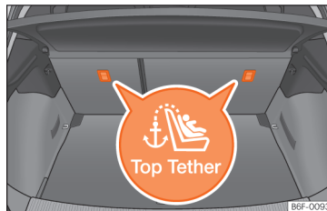
34. ábra A Top Tether-rögzítőszemek helye a hátsó ülés hátulsó részén
