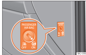
94. ábra Kulcsos kapcsoló a vezető melletti ülés légzsákjának be- és kikapcsolásához.
