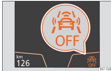
232. ábra A műszerfalbetét kijelzőjén: kikapcsolt Front Assist jelzése.
