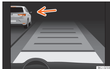
239. ábra A műszerfalbetét kijelzőjében: ACC aktív, jármű felismerése a bal oldalon
