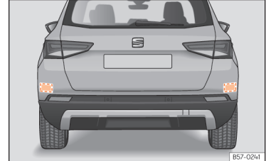
272. ábra A jármű hátsó nézete: a radarérzékelők tartományai.
