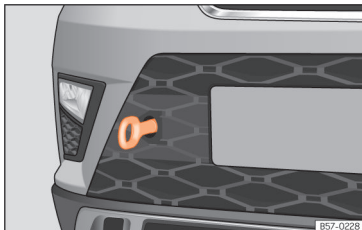
102. ábra Az első lökhárító jobb oldalán: becsavart vonószem.
