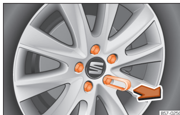
75. ábra Kerék: keréksavarok védőkupakok- kal.
