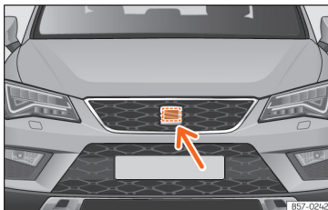
255. ábra A jármű elején a SEAT-embléma mö-gött: radarérzékelő.
