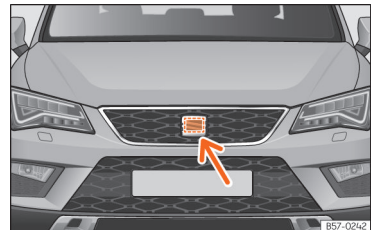
260. ábra A jármű elején a SEAT-embléma mögött: radarérzékelő.
