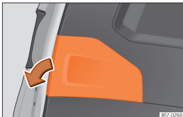
116. ábra Nyitott csomagterájtó: távolítsa el a védőburkolatot
