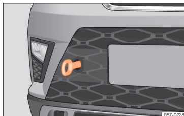
80. ábra Az első lökhárító jobb oldali részlete: becsavart vonószem
