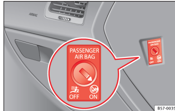
95. ábra Kulcsos kapcsoló a vezető melletti ülés légzsákjának be- és kikapcsolásához.
