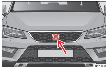
196. ábra A jármű elején a SEAT-embléma mögött: radarérzékelő.
