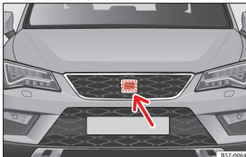
191. ábra A jármű elején a SEAT-embléma mögött: radarérzékelő.
