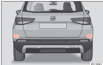
208. ábra A jármű hátsó nézete: a radarérzékelők tartományai.
