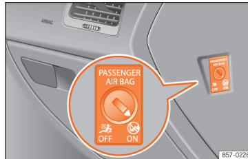
17. ábra Kulcsos kapcsoló a vezető melletti ülés légszákjának be- és kikapcsolásához.
