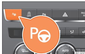
252. ábra A középkonzol felső részében: kapcsológomb a parkolási kormányzási asszisztens bekapcsolásához.
