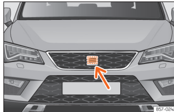
233. ábra A jármű elején a SEAT-embléma mögött: radarérzékelő.
