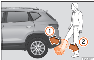
103. ábra Csomagtérajtó érzékelő-vezérelt nyitással (Easy Open).
