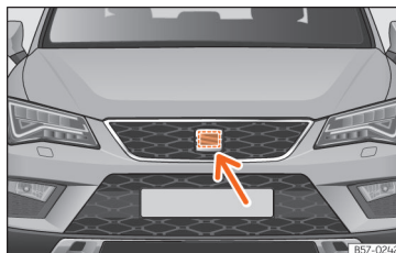
227. ábra A jármű elején a SEAT-embléma mögött: radarérzékelő.
