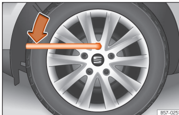
38. ábra Kerékcse: kerékcavarak meglaizítása.
