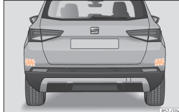
245. ábra Jármű hátsó nézete: a radarérzékelők tartományai.
