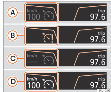
221. ábra Műszerfalbetét képernyője: sebességszabályozó berendezés (GRA) állapotjelzései.
