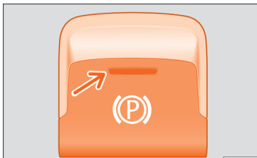
249. ábra A középkonzol alsó tartományában: elektronikus parkolófék kapcsolója.
