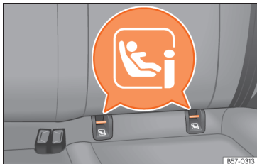
28. ábra Hátsó ülés: ISOFIX/i-Size rögzítőszemek.
