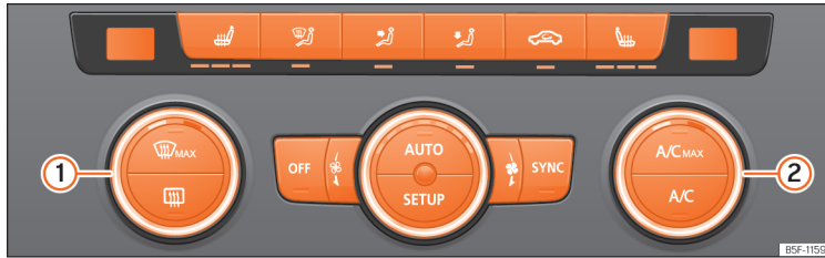
153. ábra A középkonzolban: a Climatronic kezelőelemei.
