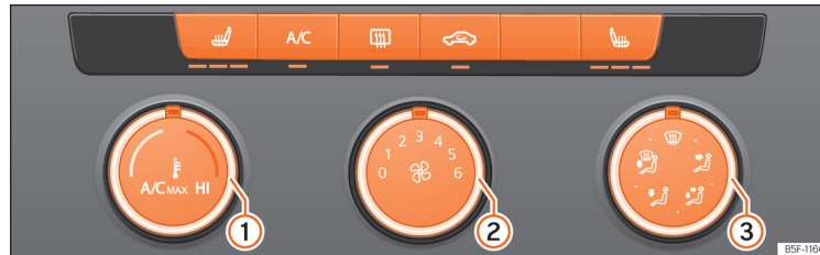
154. ábra A középkonzolban: klímaberendezés kezelőelemei.
