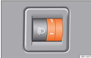
116. ábra Kormánykerék mellett: világítási távolság szabályozója.
