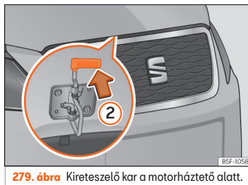
279. ábra Kireteszelő kar a motorháztető alatt.
