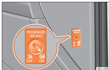
96. ábra Kulcsos kapcsoló a vezető melletti ülés légzsákjának be- és kikapcsolásához.
