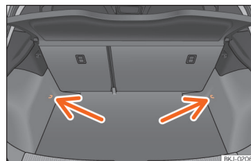
165. ábra Rögzítőszemek helye a csomagtérben.
