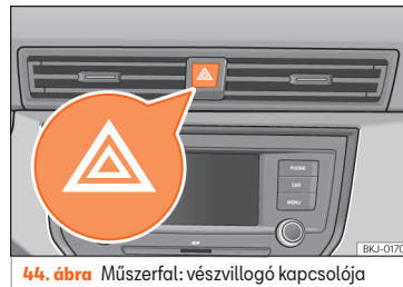
44. ábra Műszerfal: vészvillogó kapcsolója
