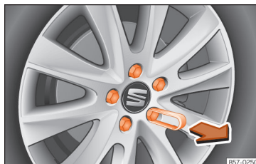
73. ábra Kerék: keréksavarok védőkupakok- kal.
