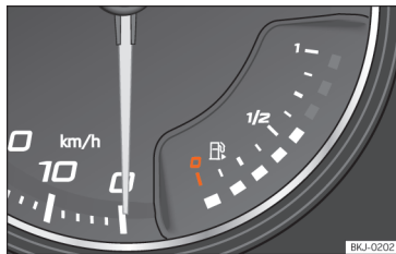
120. ábra Analóg műszerfalbetét: Üzemanyag-tartalék kijelzése
