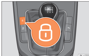
5. ábra Középkonzol: központi zár kapcsológomb.
