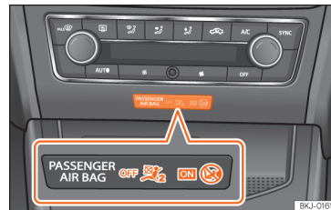
26. ábra Műszerfal középső része: ellenőrző lámpa a kikapcsolt utasoldali első légszákhoz.
