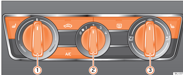
171. ábra Klímaberendezés kezelőelemei a műszerfalban.
