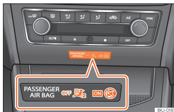
97. ábra Műszerfal középső része: ellenőrző lámpa a kikapcsolt utasoldali első légzsákhoz.
