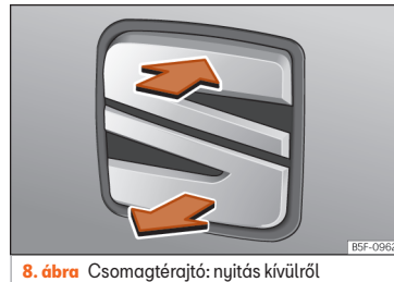
8. ábra Csomagtérajtó: nyitás kívülről
