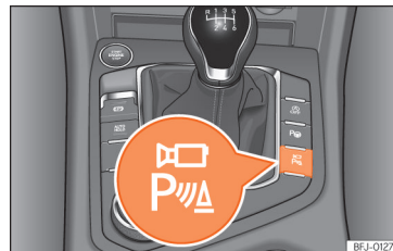
215. ábra Középkonzol: kapcsológomb a környezetfigyelés és a kapcsolódó parkolási kormányzási asszisztens manuális aktiválásra és kikapcsolásra.
