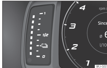
59. ábra Műszerfalbetét: akkumulátor töltöttségének kijelzése.
