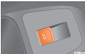
85. ábra A vezető ajtaján: gomb a csomagtérajtó nyitásához és zárásához.
