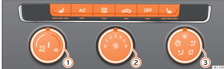
147. ábra A középkonzolban: klímaberendezés kezelőelemei.
