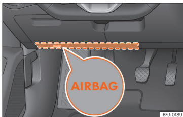
19. ábra A vezető oldalán: a térdlégzsák beépítési helye.
